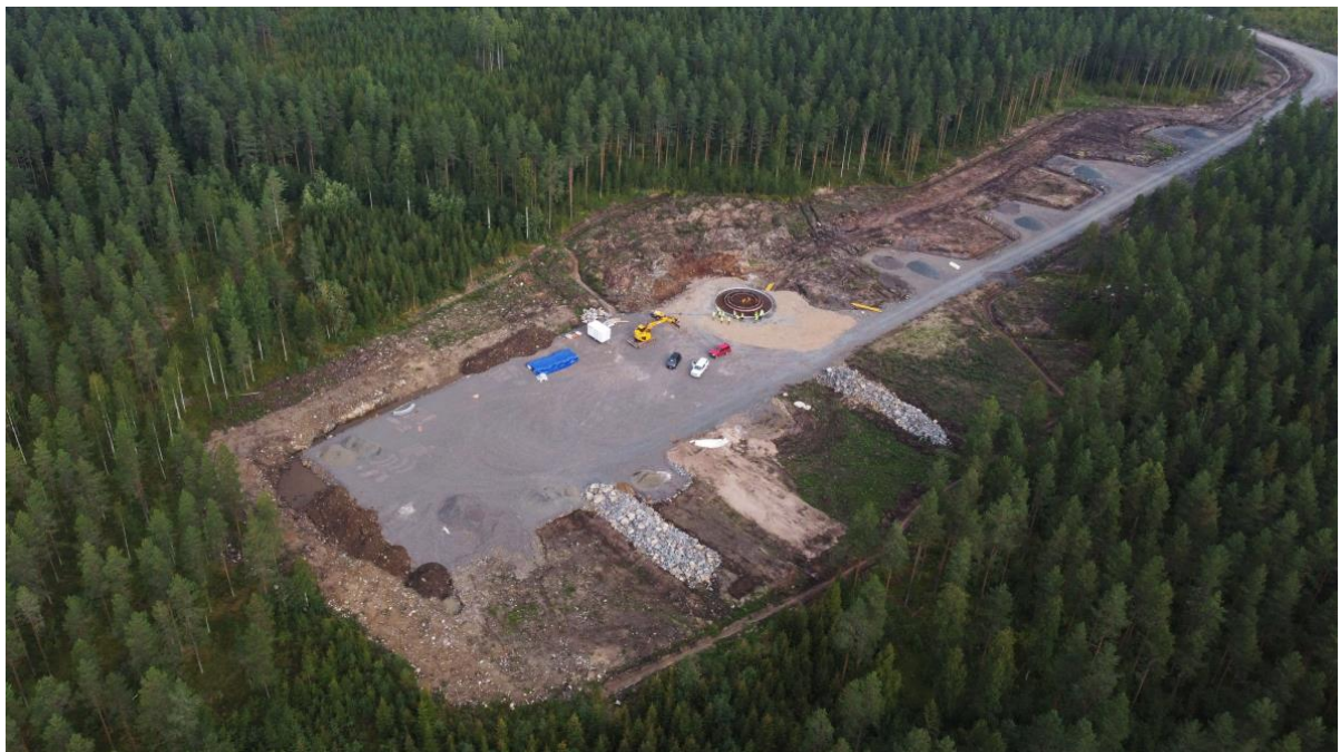
Kuva 6-5. Esimerkkikuva tuulivoimalan kenttä- ja nostoalueesta. (Oka Nuutinen, 2024)
