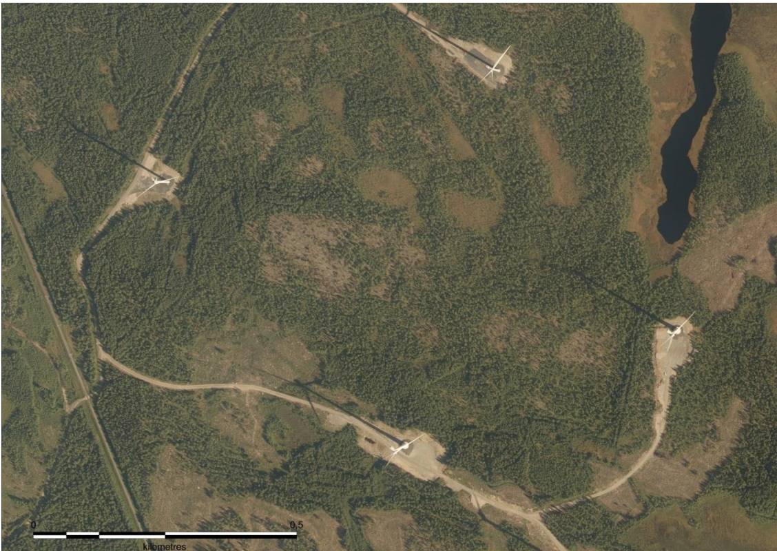
Kuva 4-1. Ilmakuvassa näkyy toiminnassa olevia tuulivoimaloita. Tuulivoimaloita varten on rakennettu huoltotiet ja nostokentät. Tuulivoimaloiden ympäristössä ja välialueilla aikaisempi maankäyttö on säilynyt ennallaan.
