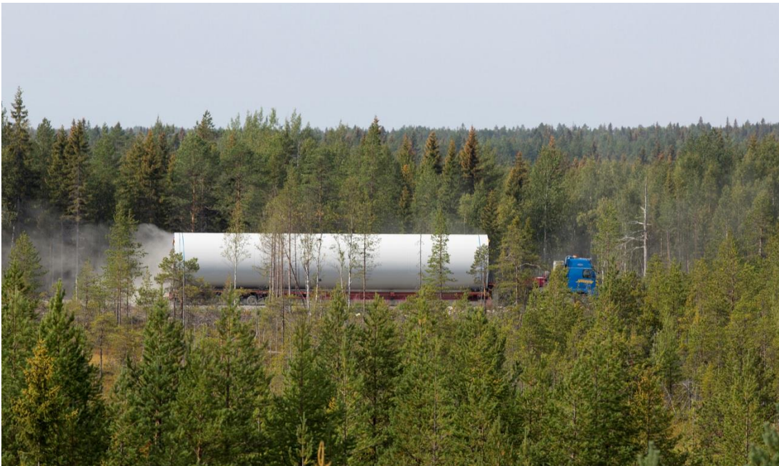
Kuva 4-16. Tuulivoimalan torniosien kuljetusta. (Kuva: Ville Suorsa, FCG).
